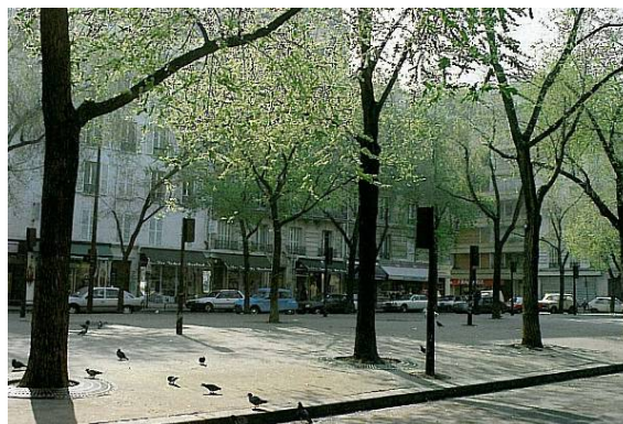
Place publique en sol en stabilisé (Paris)
